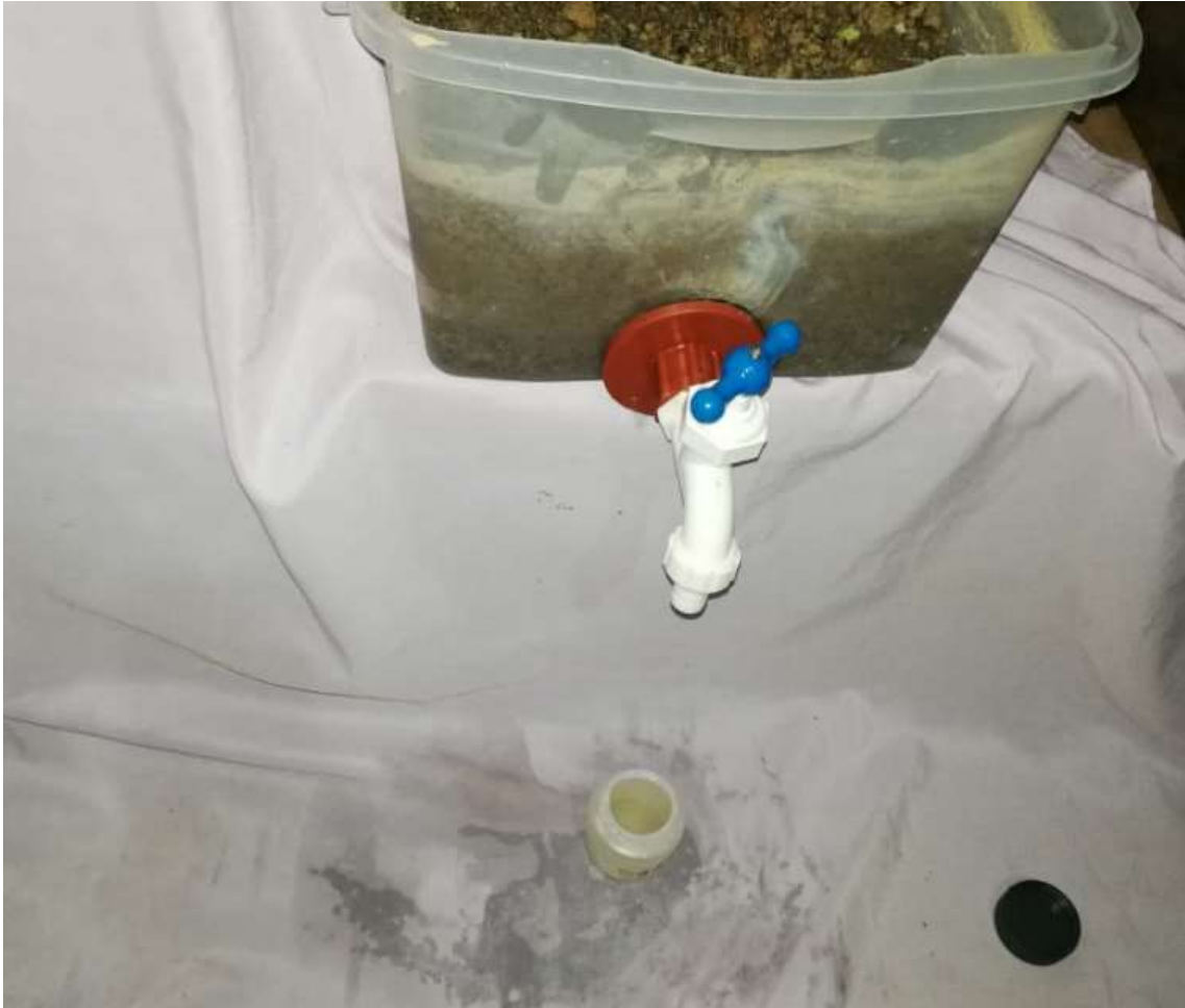
Anexo M: Recolección de la muestra a la salida del humedal superficial para su respectivo análisis
