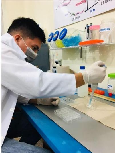
**Ilustración 10.** Preparación cajas de Micro pocillos con las muestras (1, 2, 3) a diferentes diluciones (100%, 85%, 75%, 50%)
