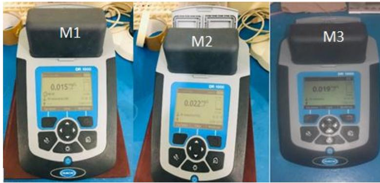
**Ilustración 7.** Concentraciones de Cromo Hexavalente determinados en el Espectrofotómetro UV-Visible DR1900 Marca Hach.
