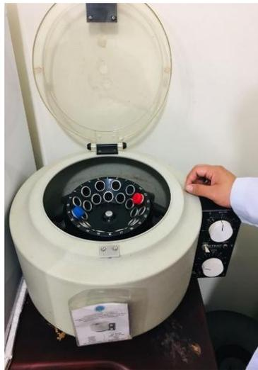
*Ilustración 5. Centrifugación para obtener el Pellet.*
