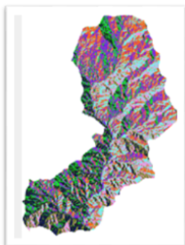
Figura 8. Imagen raster de dirección de flujo
