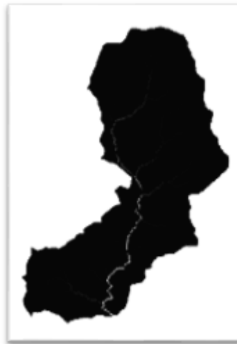
Figura 9. Raster de acumulación de flujo
