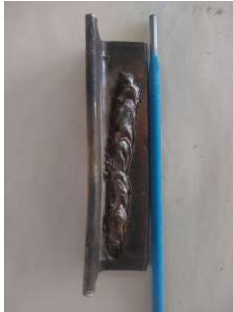
Imagen 20 muestra de cordón realizado con electrodo E-6013
