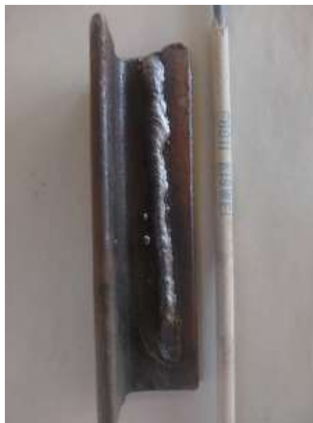
Imagen 22 muestra de cordón realizado con electrodo E-6011
