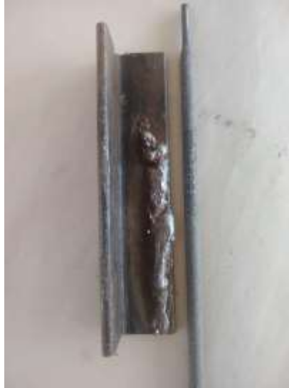
Imagen 21 muestra de cordón realizado con electrodo E-7018
