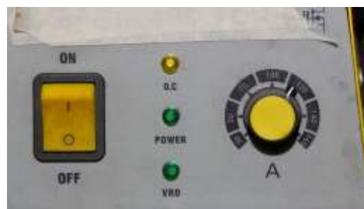
Imagen 14 sistema regulador del amperaje maquina soldadora
