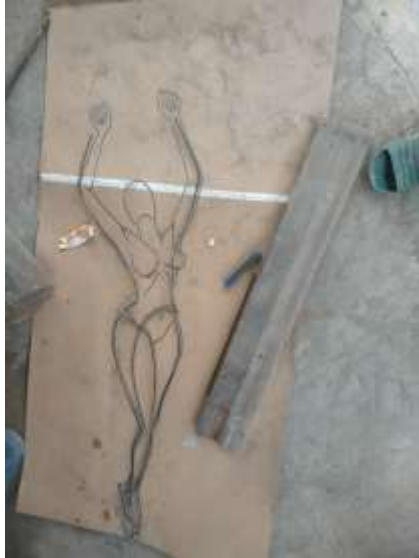
Imagen 24 varillas dobladas conforme a la figura del plano
