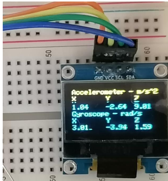
Figura 32: Señales del sensor MPU6050 en el display SSD1306
