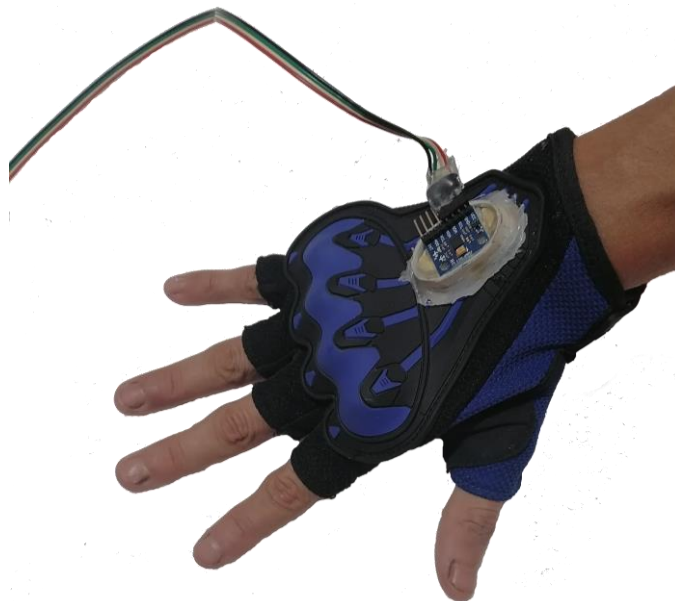
Figura 15: Ubicación del sensor MPU6050 en el guante
