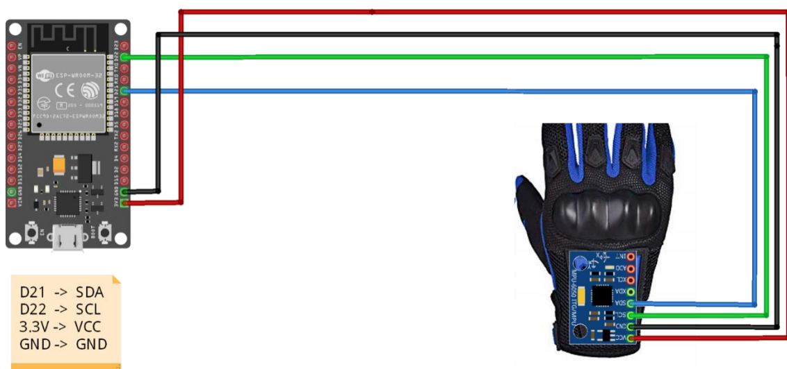
Figura 16: Esquema de conexión del sensor MPU6050 con el ESP32
