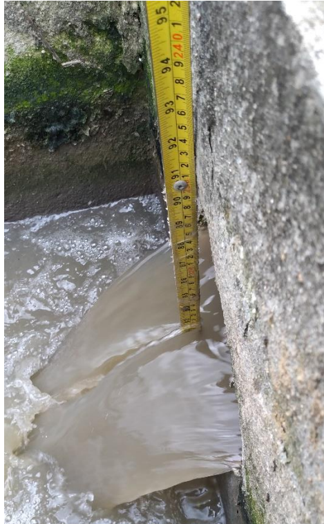
Figura 13. Tirante de agua en el tubo de entrada
