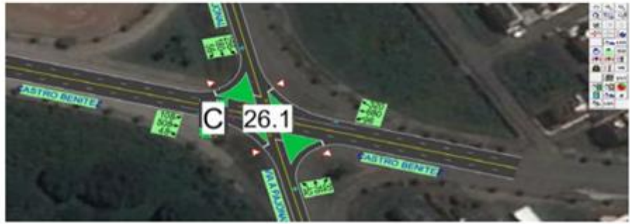
Figura 3. Nivel de servicio y tiempo de demora, al colocar un sistema de semaforización
