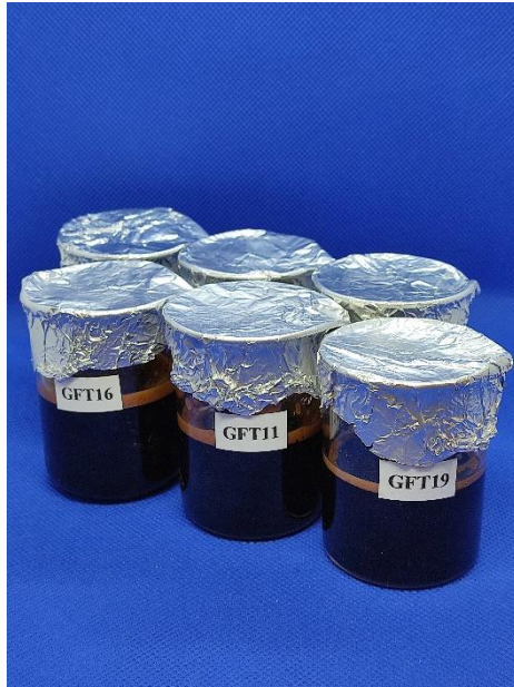
Anexo 3. Muestras de geles de taninos condensados al ingreso de la estufa a una temperatura de 85°C y 100% de ventilación para la gelificación.
