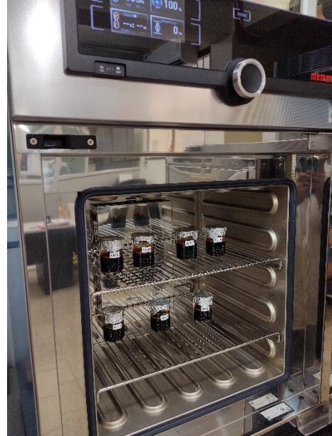
Anexo 3. Muestras de geles de taninos condensados al ingreso de la estufa a una temperatura de 85°C y 100% de ventilación para la gelificación.
