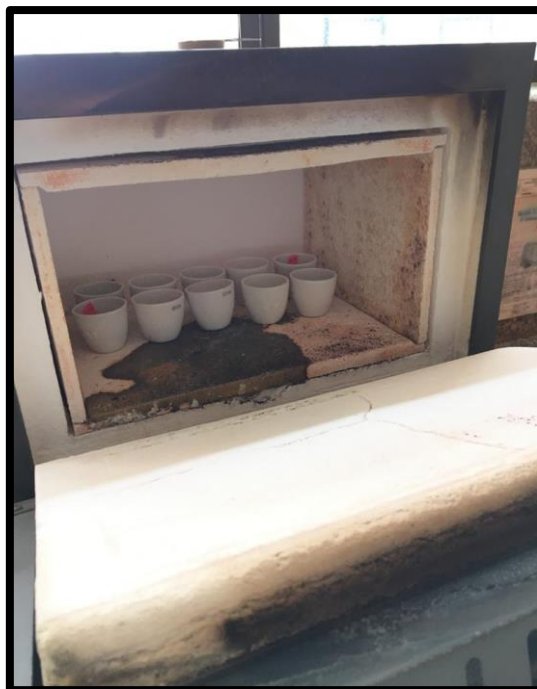
Anexo 12. Muestras de cacao secas en la mufla para análisis de ceniza.
