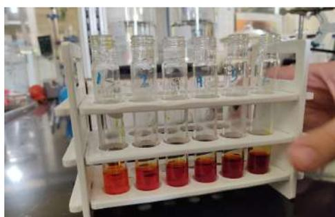
**Anexo 12. Muestras para curva de calibración DNS azúcares reductores**
