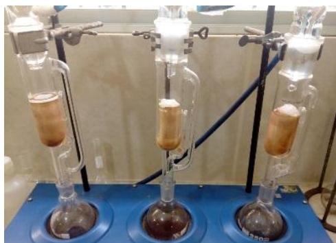
Figura 39: Extracción de grasas por el Método Soxhlet
