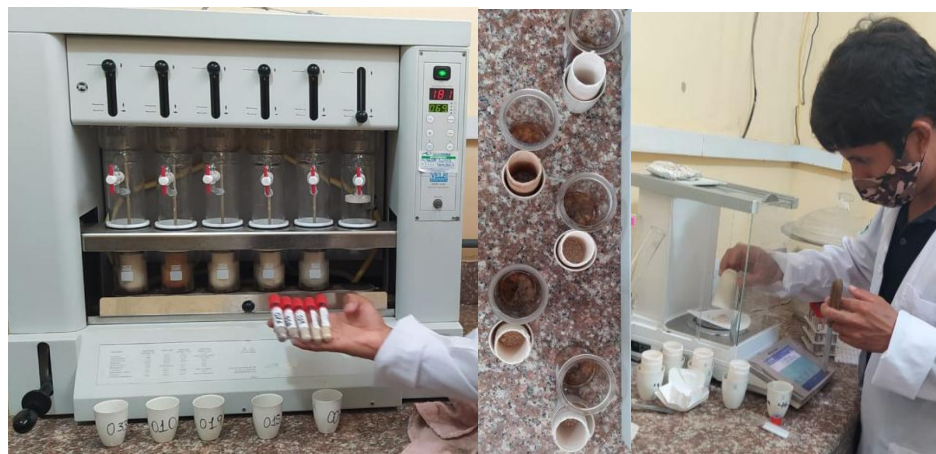
Figura 40: Proceso de extracción de grasas en la semilla para las 45 accesiones de maní
