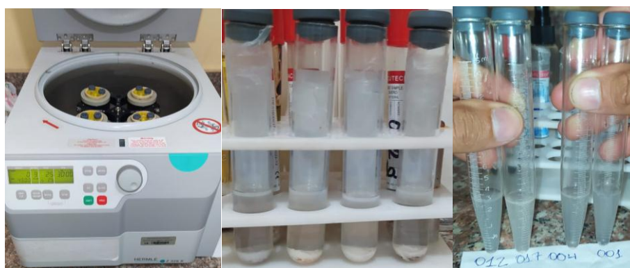
Figura 42: Proceso de la extracción acuosa de las semillas de las 45 accesiones de maní usados para la cuantificación de fenoles y antioxidaes.
