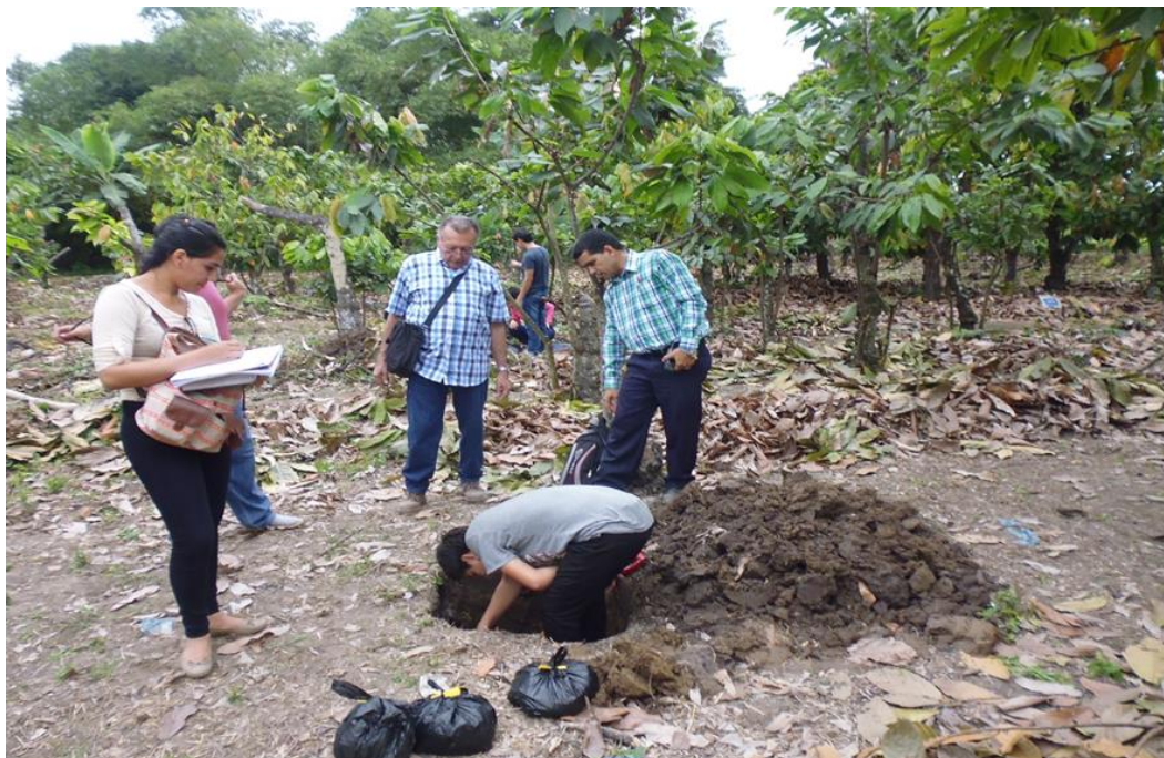
Anexo 5. Se efectuó la medición de las profundidades a evaluarse (0-15, 15-30 y 30-45) en el perfil.
