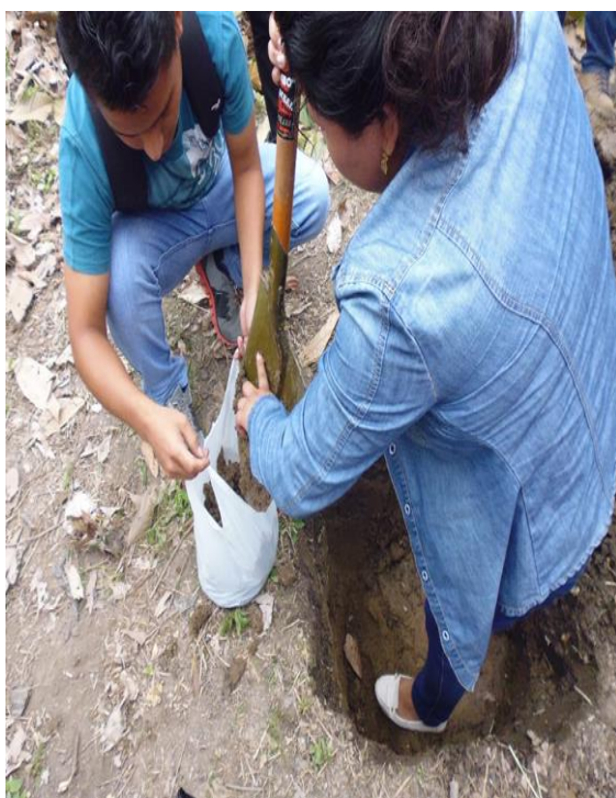
Anexo 6. Se realizó la toma de las muestras de suelo, embalaje y etiquetado para ser llevadas al laboratorio de suelos.
