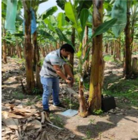
**Anexo 7.** Medición resistencia a la penetración del suelo.
