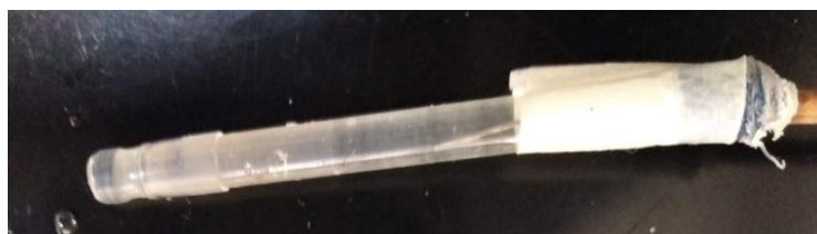
Ilustración 5: Electrodo de referencia (alambre de plata con una solución saturada de KCl) Fuente: Elaboración propia
