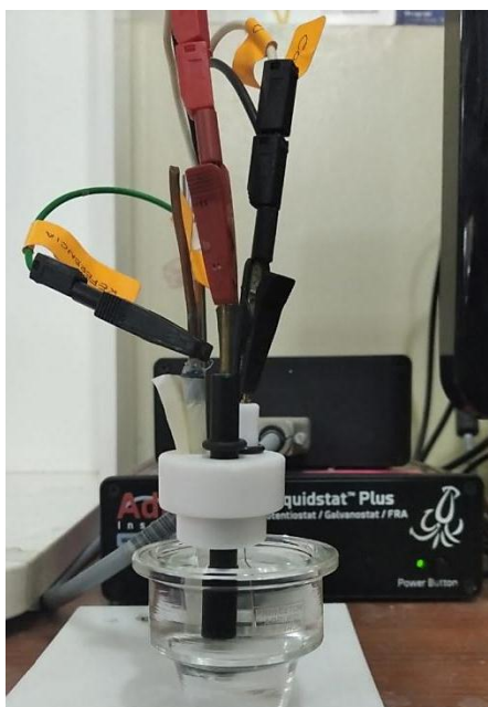
Ilustración 2: Potenciostato/Galvanostato, celda electroanalítica, electrodo de trabajo, referencia y contraelectrodo.
