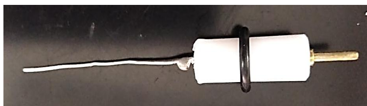
Ilustración 4: Contraelectrodo (alambre de platino) Fuente: Elaboración propia
