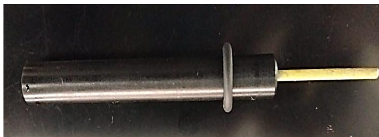
Ilustración 3: Electrodo de trabajo (electrodo de teflón dopado con punta de oro). Fuente: Elaboración propia
