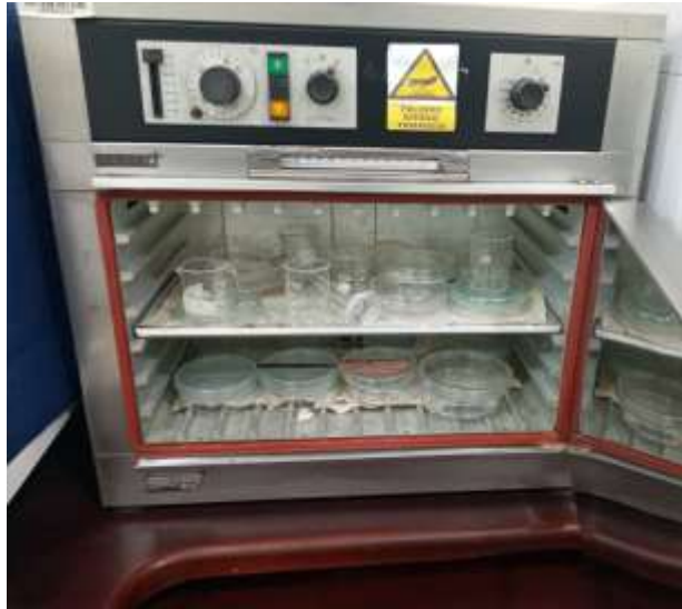
Ilustración 14. Esterilización de materiales
