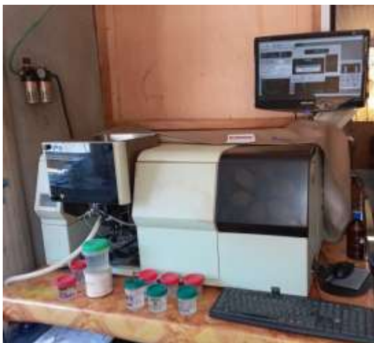
Ilustración 20. Análisis de metales espectrofotometría de absorción atómica por flama de acetileno de marca Perquin El mer 300.
