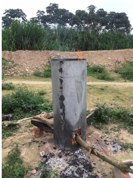
Figura 14. Horno artesanal en proceso de pirolisis Fuente: Autor
