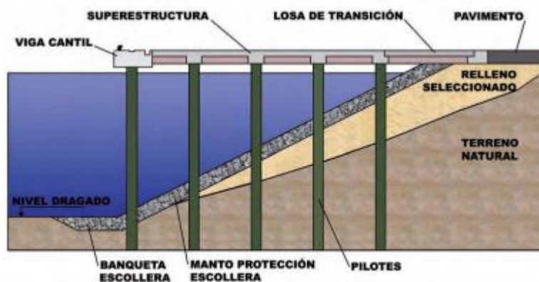
Figura 5: Sección de muelle de pilotes.
