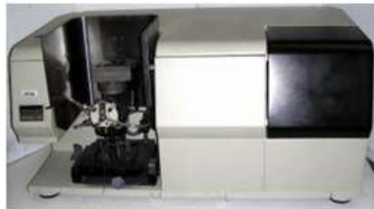
Ilustración 2. Espectrofotómetro PERKIN-ELMER AANALYST 300
