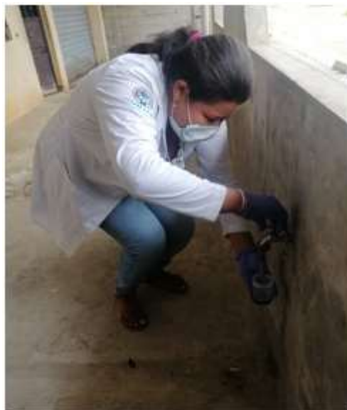
Ilustración 26. Representación de toma de muestra de agua potable
