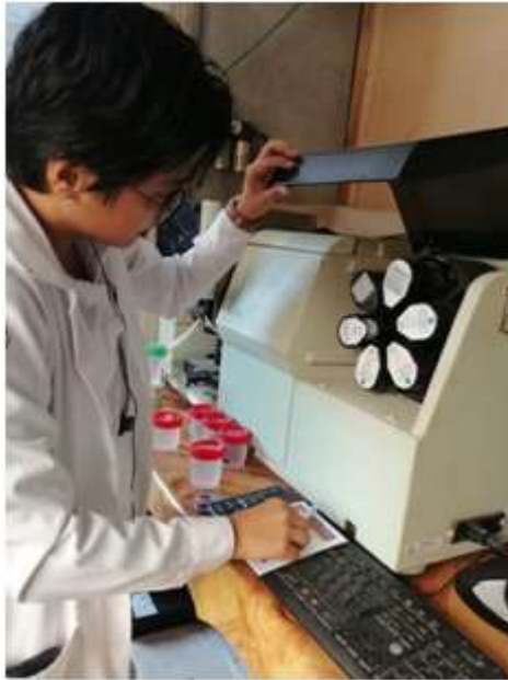
Ilustración 27. Reconocimiento del equipo en función a la Determinación de Cadmio (lámpara de Cadmio)
