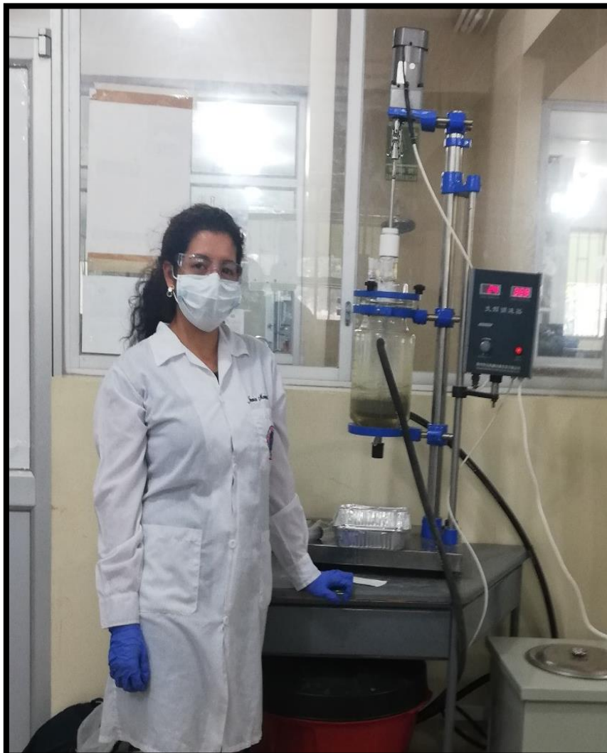
Ilustración 9 Lixiviación por agitación para la recuperación de oro
