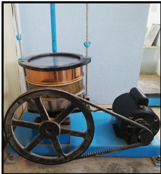
Ilustración 2 Preparación de muestra: Tamizado
