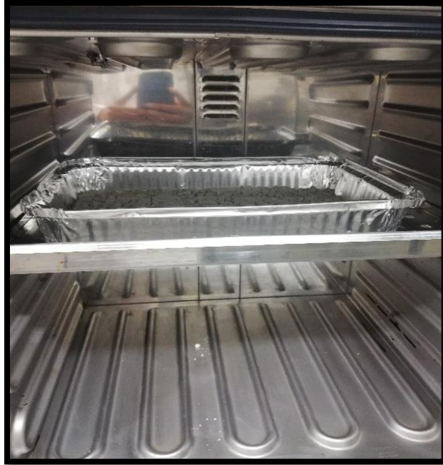
Ilustración 1 Preparación de muestra: Secado
