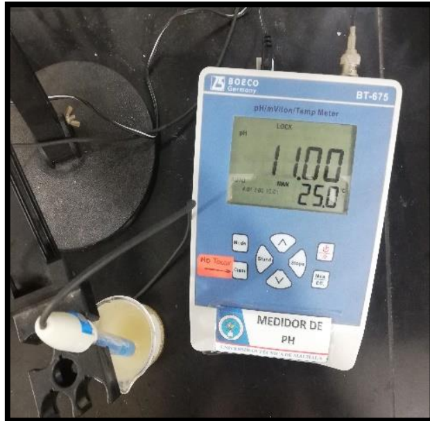
Ilustración 7 Medición de pH
