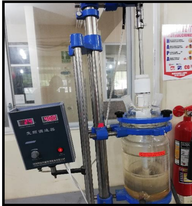
Ilustración 5 Lixiviación por agitación
