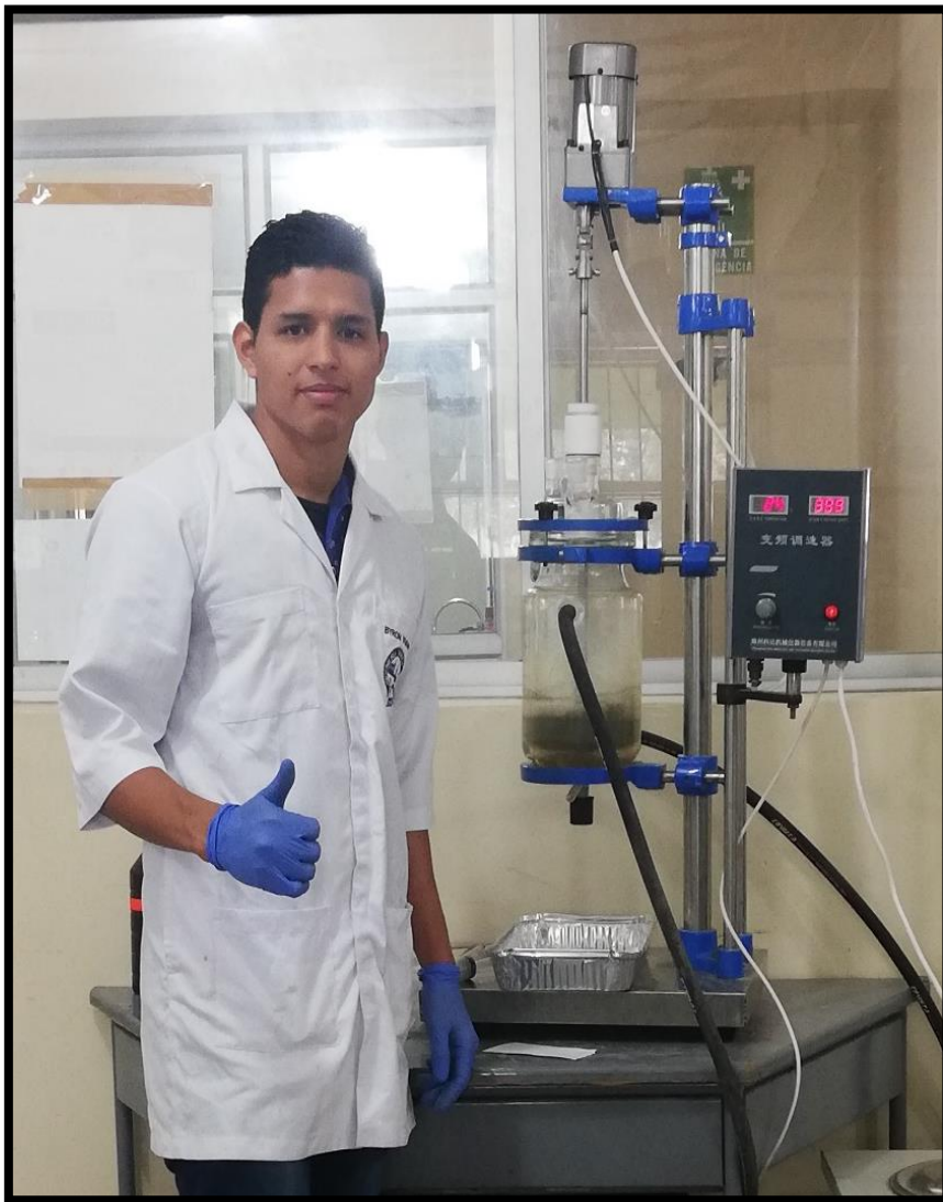
Ilustración 10 Lixiviación alcalina por agitación
