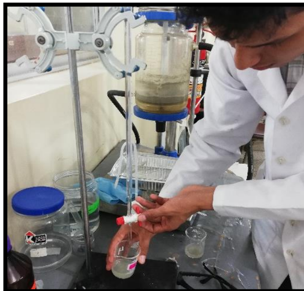
Ilustración 6 Cuantificación volumétrica del agente lixiviante
