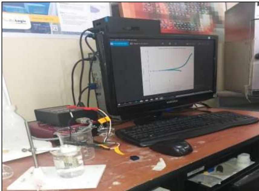
Anexo 11 . _Potenciostato Parstat MC para la medición de circuito abierto y curvas de polarización.
