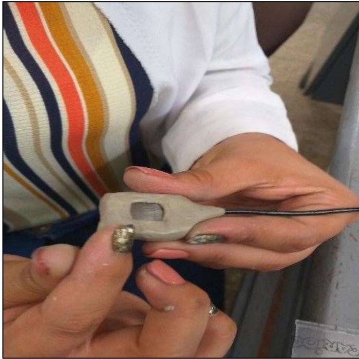
Anexo 4._ Colocar la masilla epóxica.
