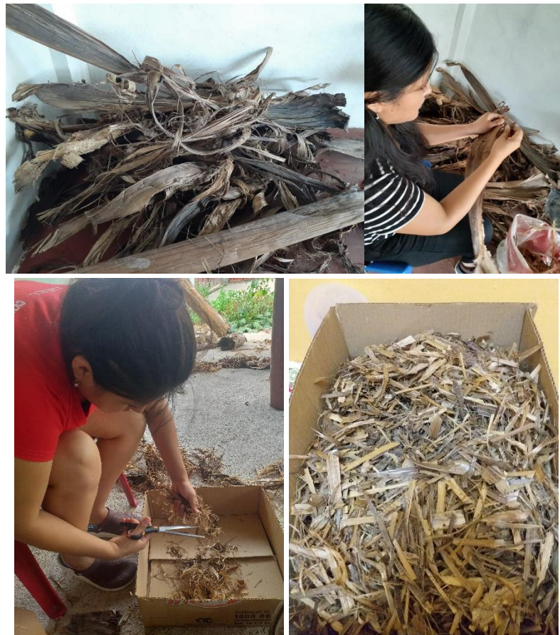
Fotografía 12: Elaboración de la fibra de tallo de banano.
