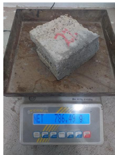
Fotografía 18: Colocación de los bloques al horno por 24 horas para después ser pesados.
