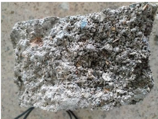
Fotografía 21: Bloque con aserrín con un 2%
