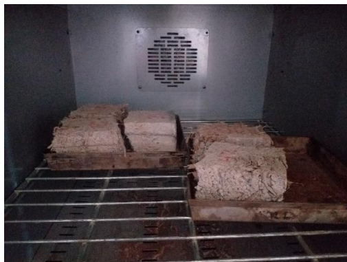
Fotografía 18: Colocación de los bloques al horno por 24 horas para después ser pesados.
