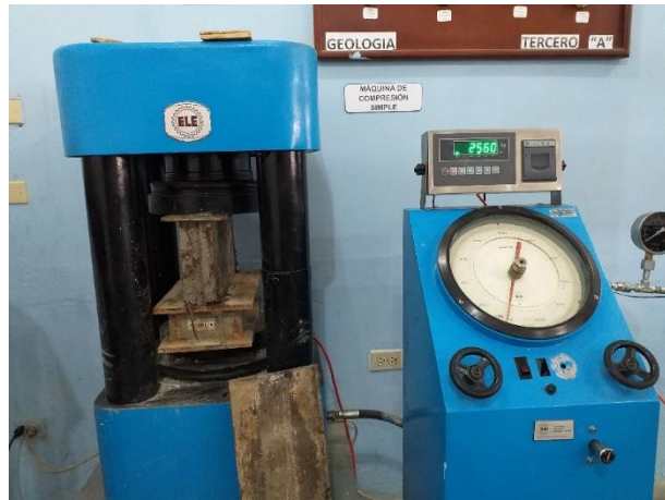
Fotografía 20: Ensayo de resistencia de compresión a los 7,14 y 28 días de los especímenes con fibra de tallo de banano y aserrín.
