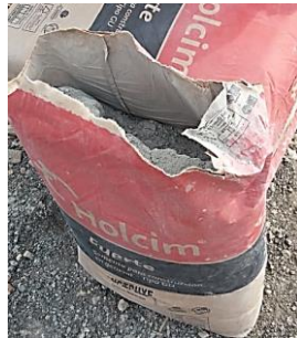
Ilustración 1: Cemento Portland Tipo 1. Fuente 3: Autora
