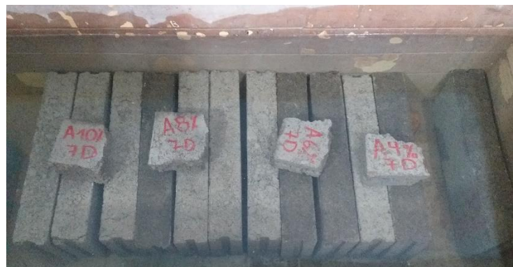
Fotografía 17: Saturación de los bloques 24 horas.
