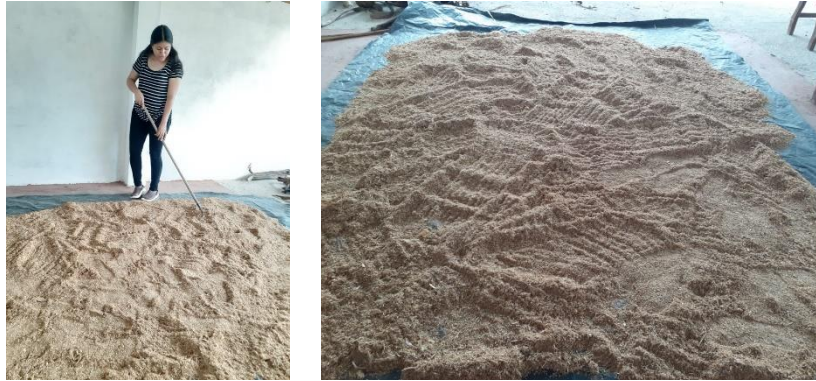
Fotografía 11: Secado de aserrín
