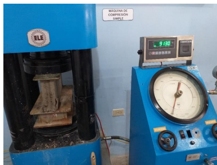
Fotografía 8: Resistencia a la Compresión del Bloque de Aserrín con el 2% a los 28 días.
