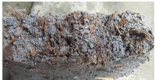
Fotografía 22: Bloque con fibra de tallo de banano con un 6%.
