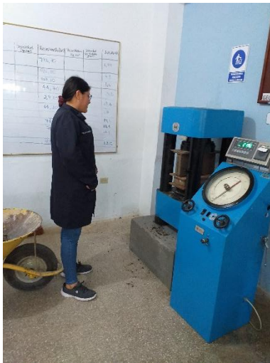
Fotografía 20: Ensayo de resistencia de compresión a los 7,14 y 28 días de los especímenes con fibra de tallo de banano y aserrín.
