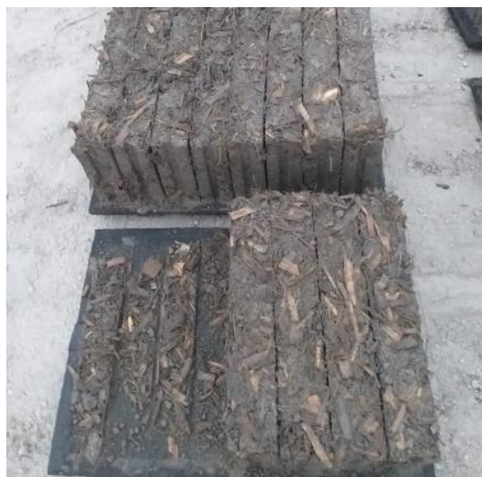
Fotografía 9: Bloque de fibra de tallo de banano con un 10%
