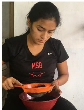
Figura 4. Tamizado del biocarbón
