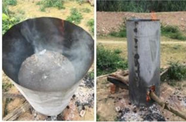
Figura 3. Horno de doble fondo para obtener biocarbón
