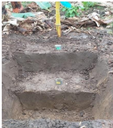
Figura 12: Calicata en forma de escalera en estratos de 0-25 y de 25-50 cm
