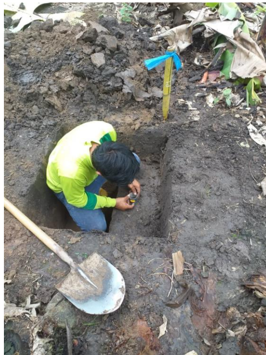
Anexo 2: toma de muestra con el cilindro a una profundidad de 25-50 cm para la determinación de la densidad aparente
