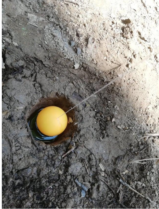
Anexo 4. Determinación de la conductividad hidráulica a través del método inverso de Auger Hole.
