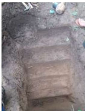
Anexo 10: Calicata para la toma de muestras
