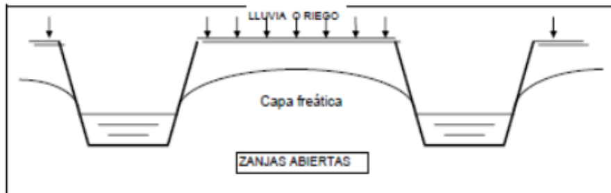
Figura 3: Sistemas de drenaje de zanjas abiertas (Villon, 2007).
