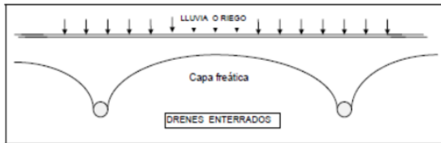
Figura 4: Sistema de drenaje subterráneo (Villon, 2007).
