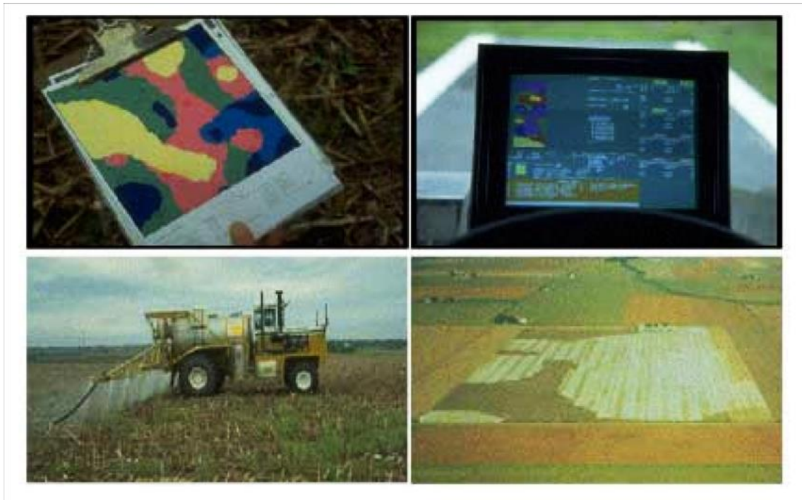
Figura 3. Distribución de dosis variables de fertilizantes de acuerdo al mapa de suelos digitalizado usando SIG.
