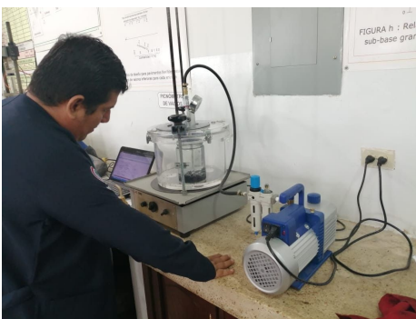
FIG.17: Prueba de Picnometro de vacíos para el cálculo de la gravedad Máxima medida (RICE)
