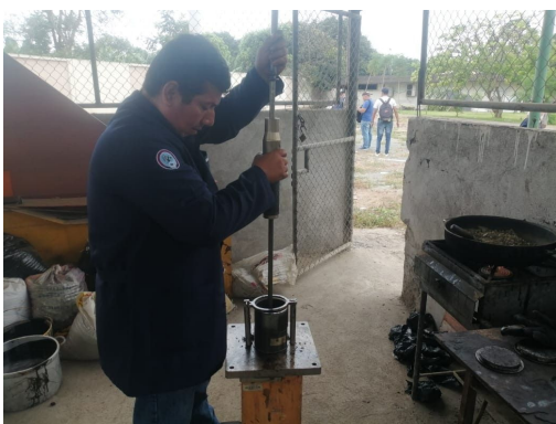
FIG.11: Colocación de mezcla en cilindros y compactación
