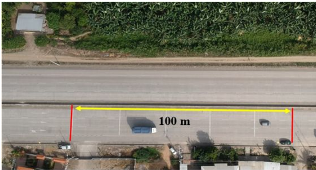
Figura 4. Aforo de velocidades mediante Drone
