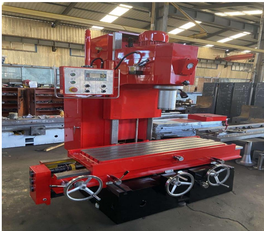
Ilustración 4. Maquina rectificadora de cilindro de motores
