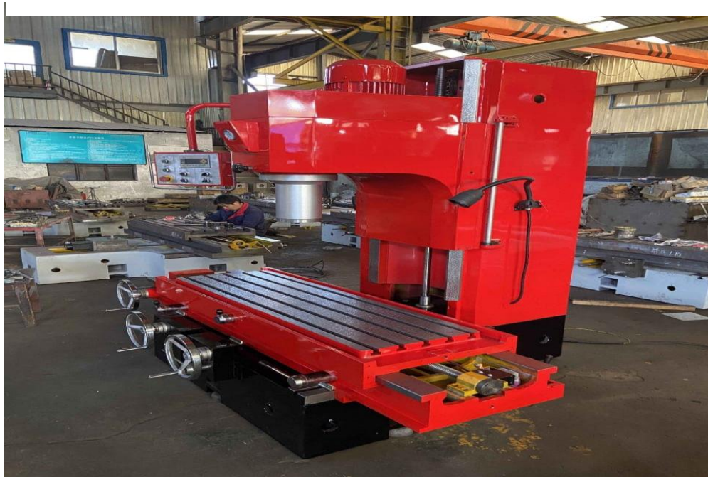
Ilustración 6. Maquina rectificadora de cilindro de motores (lateral)
