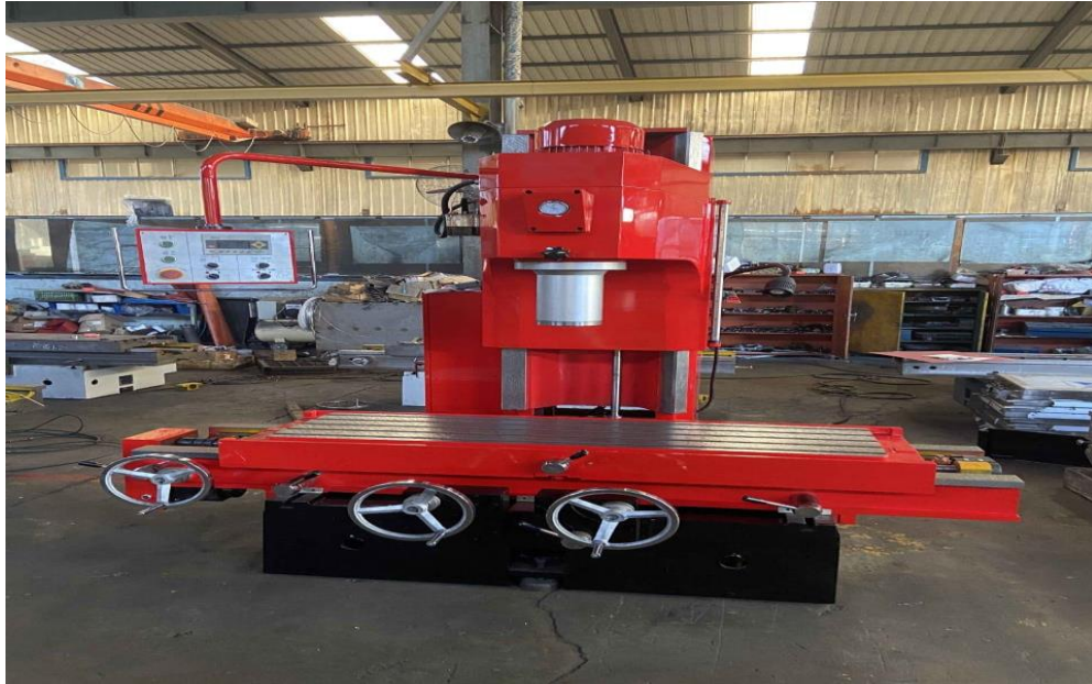
Ilustración 5. Maquina rectificadora de cilindro de motores (lado frontal)
