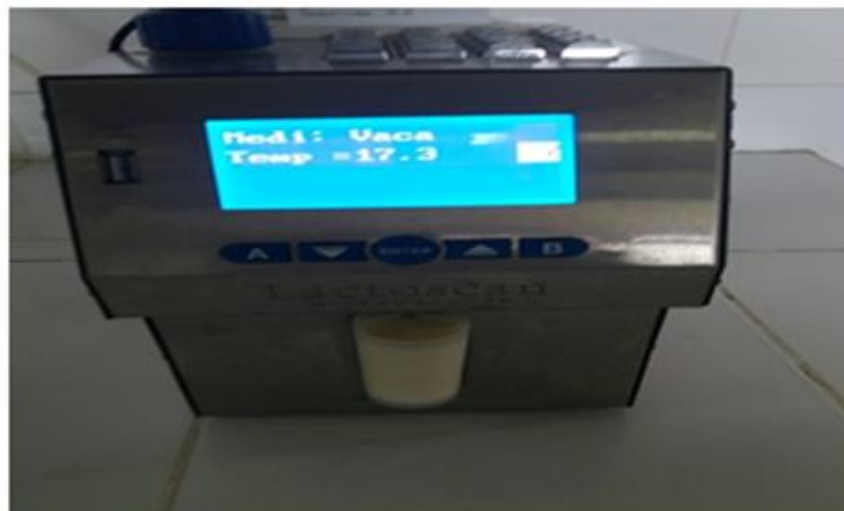
Determinación del pH, temperatura, densidad y porcentaje de grasas en el equipo Lactoscan
