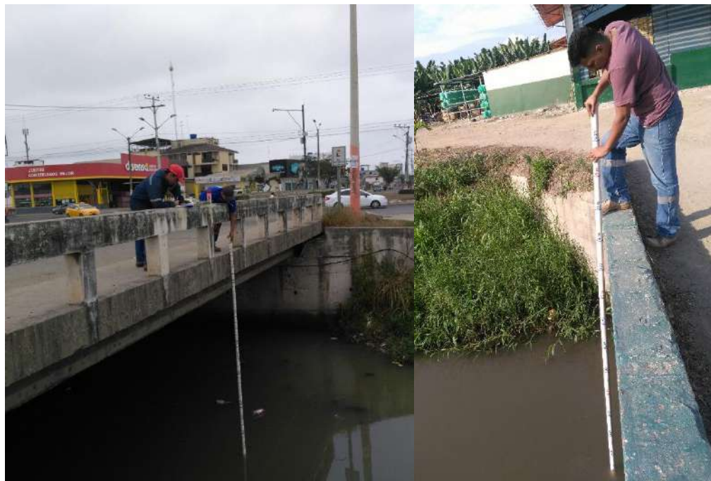
TF 6. Trabajos de aforo al canal El Macho.
