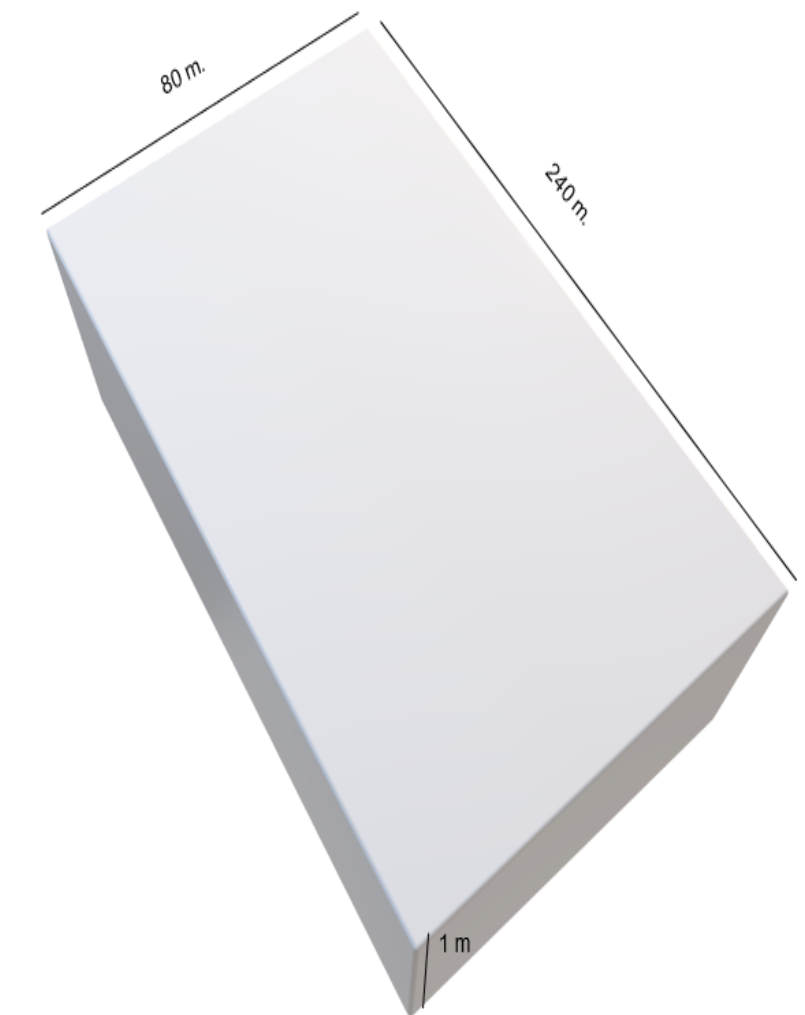
Ilustración 25. Laguna de maduración
