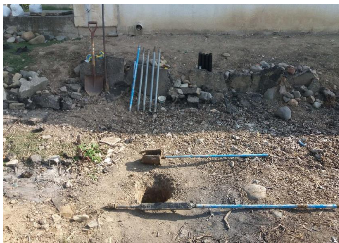
Ilustración 6: Herramienta manual posteadora, martillo y barras Fuente: Autor
