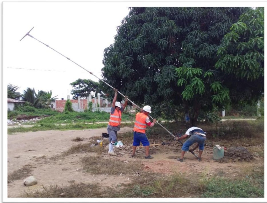
Extractor de muestras inalteradas con tubo shelby, sondeo 1
