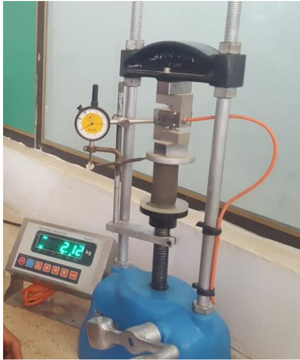
Ilustración 24: Equipo para realizar la prueba de compresión simple Fuente: Autor
