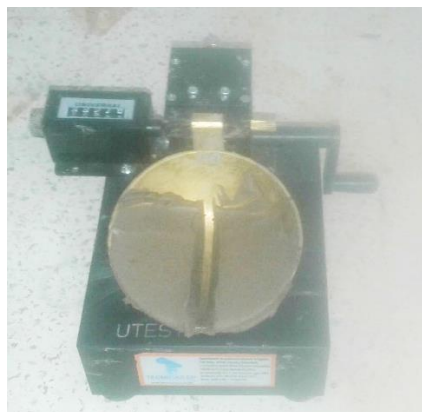
Ilustración 13: Ranura copa Casagrande Fuente: Autor
