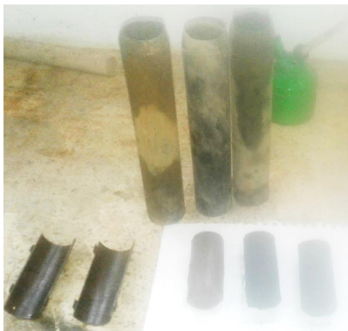
Ilustración 7: Muestras extraídas de los tubos shelby Fuente: Autor
