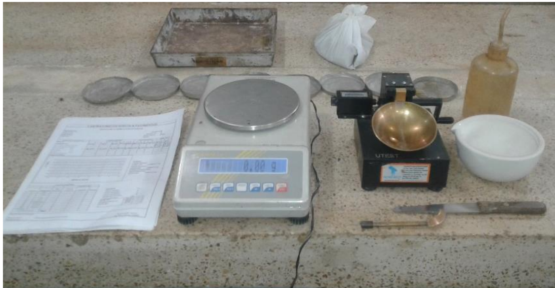
Ilustración 11: Copa de Casagrande y equipo para ensayo de limite liquido Fuente: Autor
