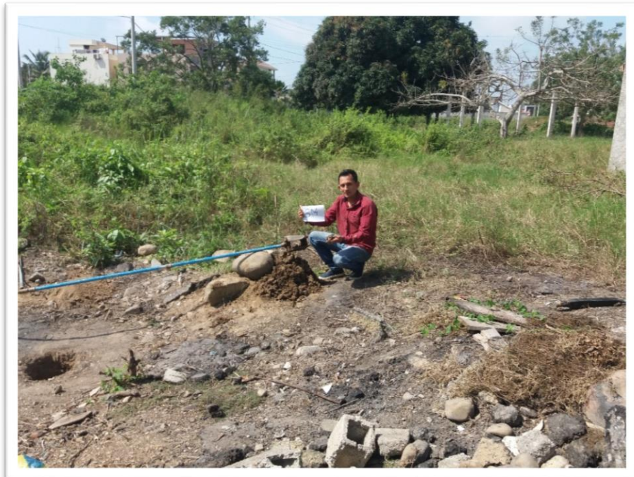
Arena limosa se encontró a los 3 metros en el sondeo 4
