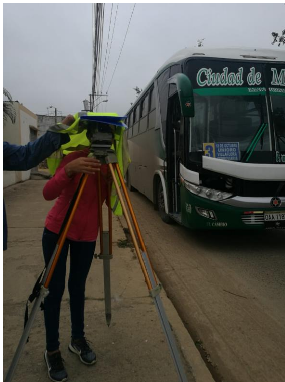
Levantamiento con nivel en la calle Guayas.
