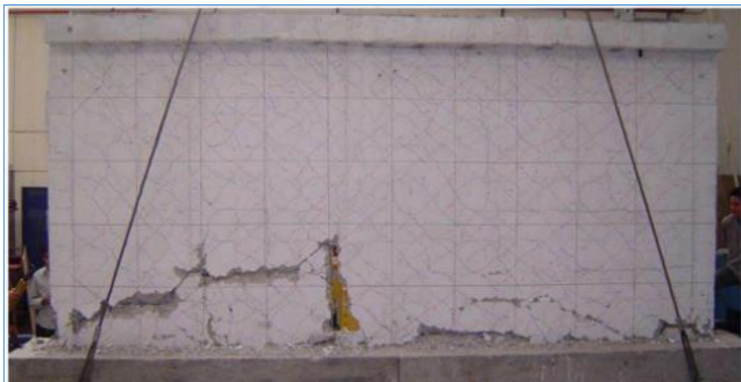
Ilustración 4. Falla por deslizamiento en la base. Fuente: Dulce García
