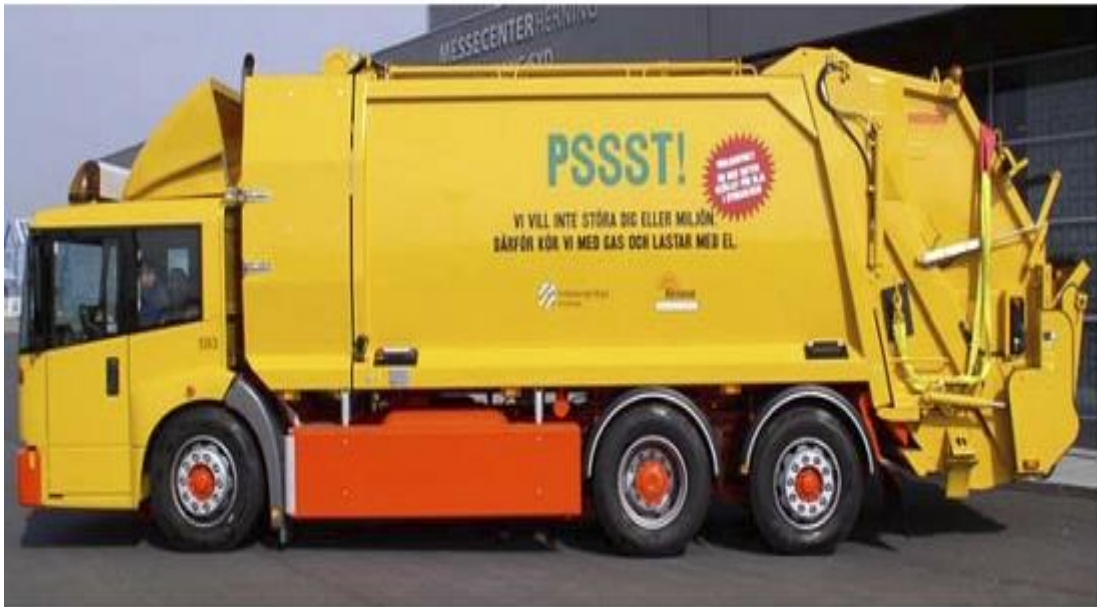
Ilustración 16. Camión híbrido para mejorar transporte de residuos directamente del contenedor
