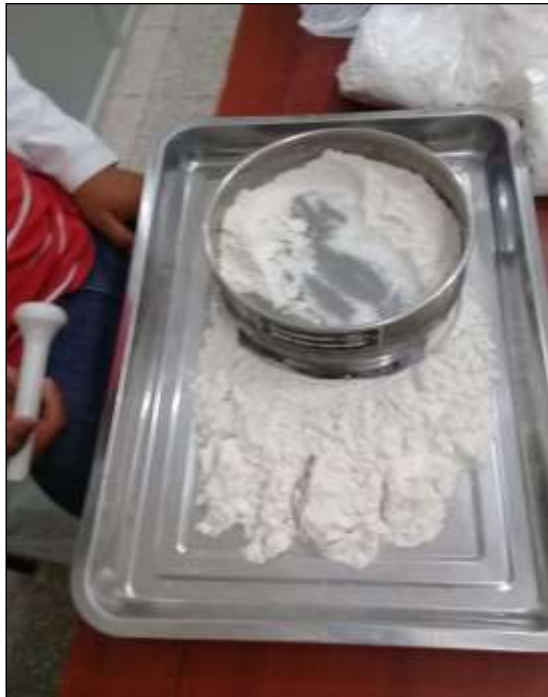
Anexo 4. Proceso de tamizaje y pesado de los almidones de malanga y achira obtenidos
