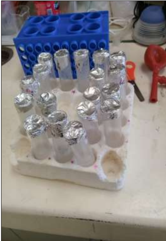
Anexo 5. Preparación de muestras para análisis de solubilidad, absorción y poder de hinchamiento de los almidones estudiados.
