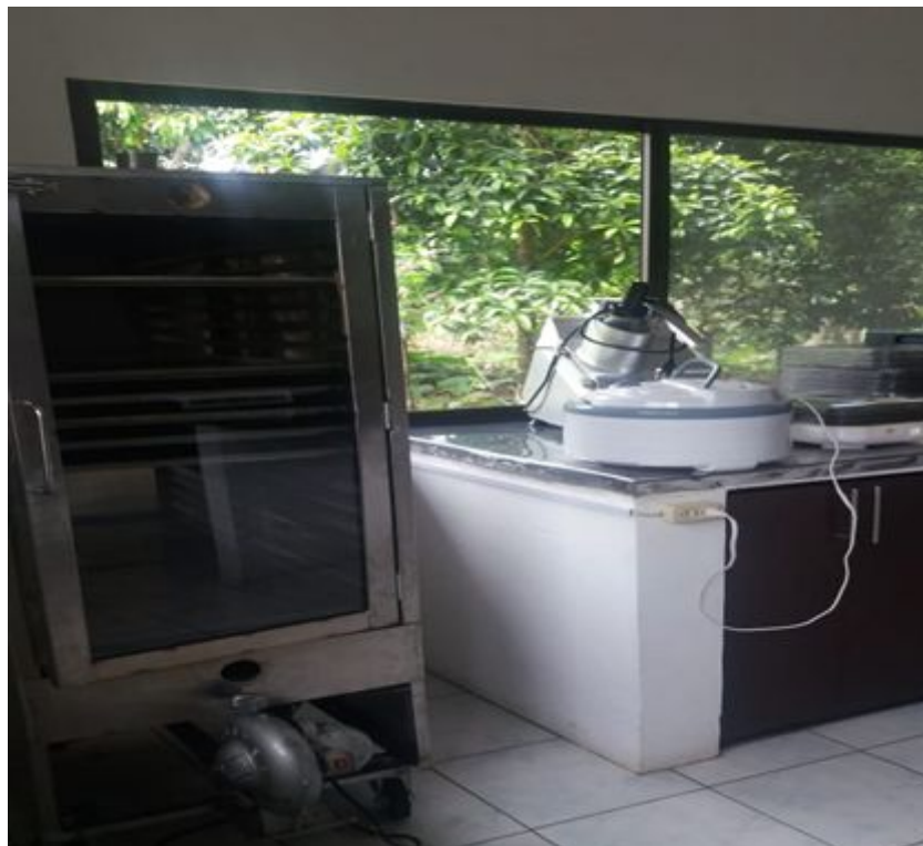
Anexo 4. Máquina para elaboración de la frutas deshidratadas
