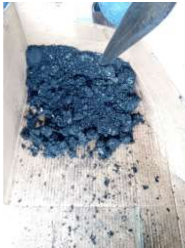
Ilustración N° 9.- Mezcla asfáltica. Fuente: El Autor, 2018.
