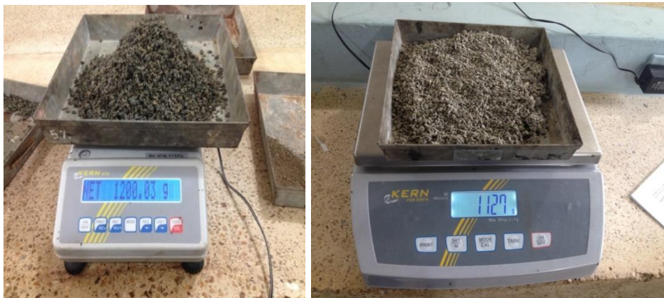
Ensayo de desgaste de los agregados gruesos mediante el uso de la Máquina de los Ángeles.
