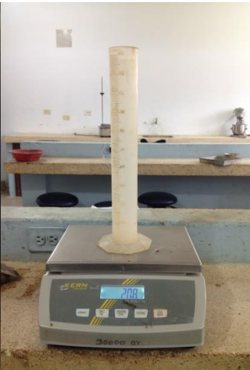
Ensayo de gravedad específica y porcentaje de absorción del agregado fino.
