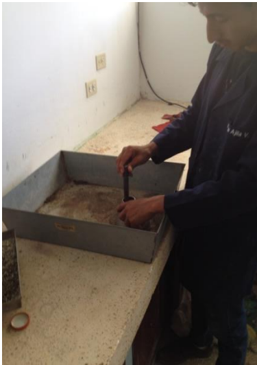
Ensayo de gravedad específica y porcentaje de absorción del agregado fino.
