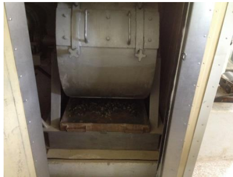
Ensayo de desgaste de los agregados gruesos mediante el uso de la Máquina de los Ángeles.
