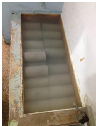
Figura 9. Curado por Inmersión Fuente: El Autor, 2018
