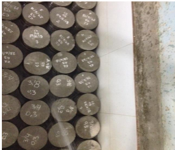
Curado de las probetas cilíndricas
