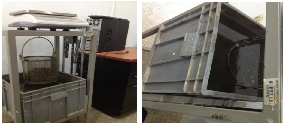
Ensayo de gravedad específica y porcentaje de absorción de los agregados gruesos.
