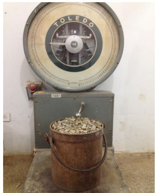
Peso volumétrico suelto y Compactado del agregado grueso.
