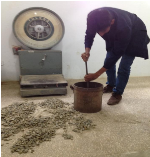
Peso volumétrico suelto y Compactado del agregado grueso.
