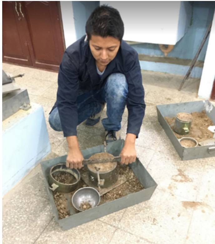
Figura 6. Ensayo de Proctor modificado
